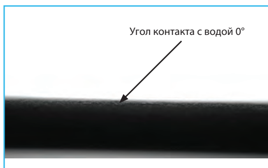
Рис. 5: Угол контакта с водой покрытия BONIT®, капли всасываются, угол контакта = 0°
